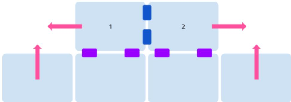
4) À chaque coin de chaque écran se trouve un trou prévu pour visser une plaque métallique une fois toutes les rangées et colonnes assemblées. Cette plaque permet d'assembler solidement les écrans par blocs de quatre, comme illustré.
