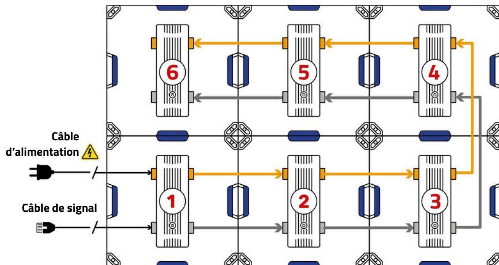
L'écran directement connecté à la source d'alimentation et à la source de données (routeur Wi-Fi ou processeur Novastar) sera désigné comme **ÉCRAN n°1** dans le flux du signal.
