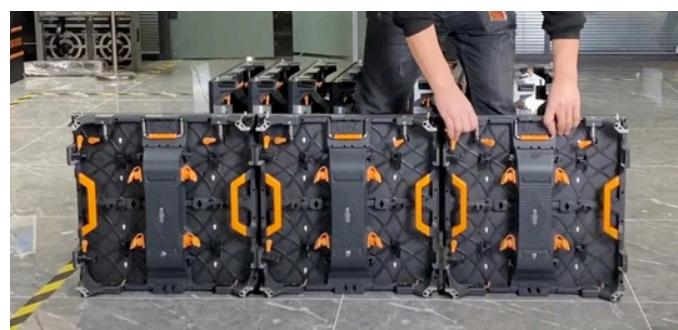
3) La disposition verticale des écrans s'effectue de la même manière que l'assemblage horizontal, à l'aide des verrous de sécurité. Sécurisez les écrans un par un, à la fois dans la colonne et sur la rangée.
