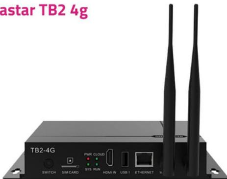
À l'instar du modèle précédent, le **Novastar TB2-4G** propose plusieurs fonctionnalités clés. De la connectivité **Wi-Fi AP** aux solutions de contrôle intégrées, en passant par des performances de traitement élevées, ce modèle assure un fonctionnement rapide, fluide et efficace.
